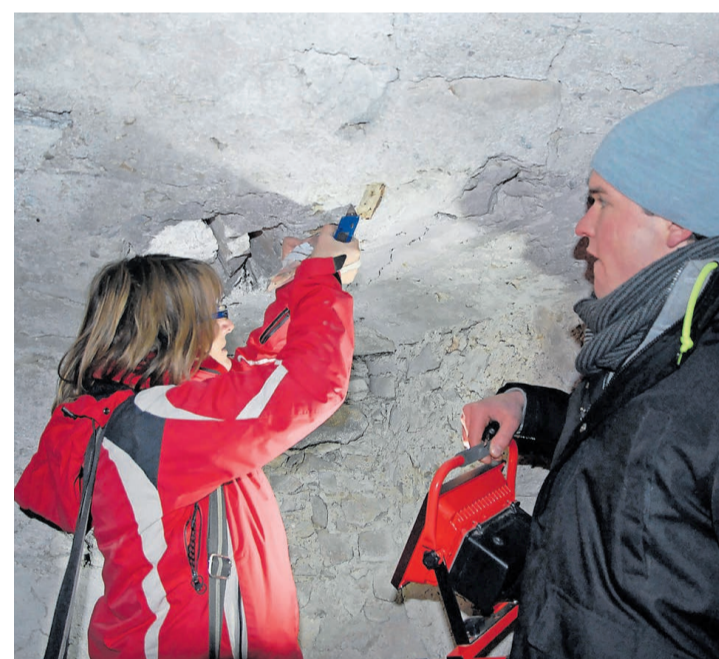
Carolin Krumm mit Architekt Markus Blumer bei der Entnahme einer Mörtelprobe im Keller des Zehntenhauses in Salez, einem Objekt, das im Buch vorgestellt wird. Bild: Hansjakob Reich
